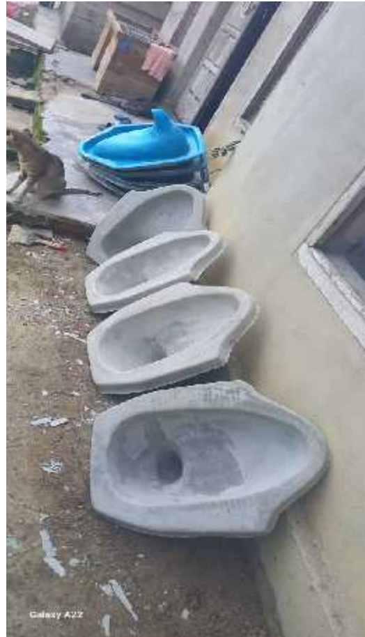
Gambar 8. Kloset yang Telah Dibongkar dari Cetakan untuk Proses Finishing dan Pengecatan
