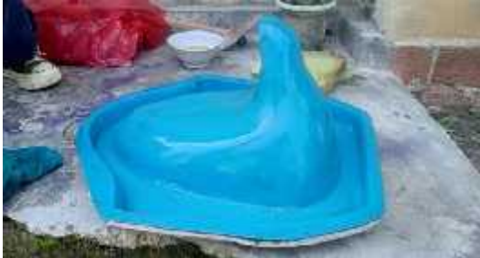
Gambar 3. Cetakan Kloset Telah Dibersihkan dan Diolesi Minyak Makan Secara Tipis
